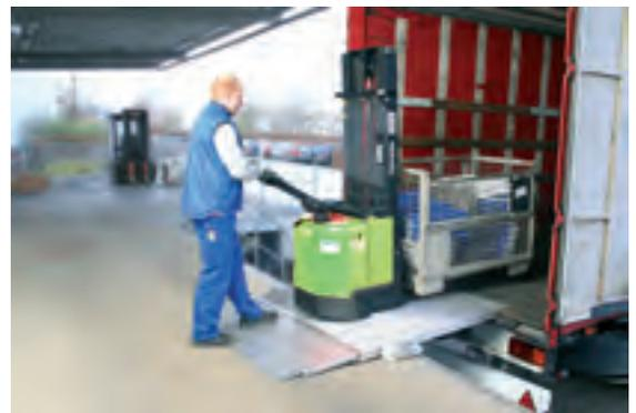
Diese Verladebrücke ist der perfekte Helfer, wenn es keine fest installierten Verladehilfen für das Be- und Entladen gibt sowie Flexibilität gewährleistet sein muss.
