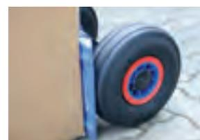
Der Radschutz aus EXLAN-Kunststoff vermeidet Beschädigungen und Verschmutzungen an empfindlichen Ladegütern.
