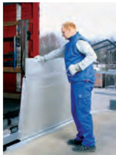
Die Anbau- und Verladebrücken sowie die Verladeschienen und -stege aus Aluminium optimieren logistische Abläufe. Mit ihnen geht das Be- und Entladen von LKWs, Transportern und Waggons reibungslos vonstatten. Die Verladehilfen gibt es in verschiedenen Größen und Tragkräften. Sicherheitsdetails, wie z.B. Gummiprofile, serienmäßige Anschlag- und Abstandhalter und Räder zum Heranfahren an den Verladeort tragen massgeblich zur Gesunderhaltung von Mitarbeitern bei.
