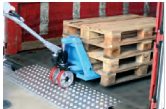
Je nach Größe des Verladestegs ist an der Unterseite mittig oder durchgängig ein Sicherheitsanschlag angebracht. Er sorgt für ein sicheres und optimales Anlegen.
