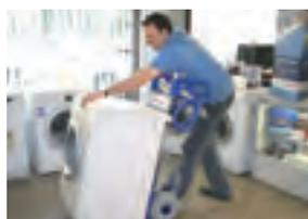
Type 823.820.21 160KL mit oben klappbarem Holm zum bequemen Ankippen. Nur bei Nutzung der starken Schaufel und der unteren Griffe beträgt die Tragkraft 300 kg.
