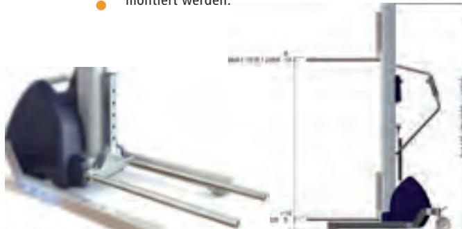
! Die Gabel kann um ± 100 mm von der Position in der Zeichnung entfernt montiert werden.
