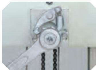
Sicherheitskurbel mit automatischer Absenksperr
