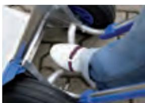
Die gebogene Form der Achse erleichtert das Ankippen auch bei schwerer Beladung und verhindert ein Abrutschen des Fußes.
