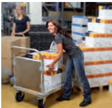
Die Aluminium-Vierradwagen sind mit je zwei Lenk- und Bockrollen ausgestattet. Gemäss der EU-Norm EN 1757-3 befinden sich Feststeller an den Lenkrollen.
