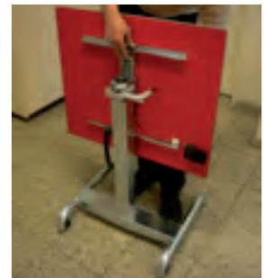
Die Höhe ist durch einfache Hebelbetätigung verstellbar. Die Plattform wird mit dem Ladegut durch die Feder-Unterstützung in der Höhe stufenlos verstell.
