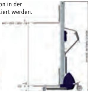
! Die Plattform kann um  $\pm 100$  mm von der Position in der Zeichnung entfernt montiert werden.
