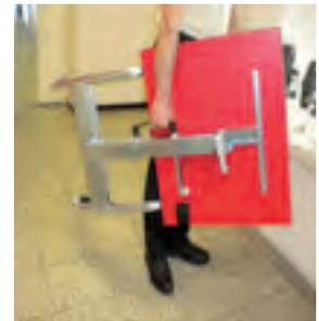
Durch einfache Entriegelung wird das Standbein aufgestellt. 2 Rollen sorgen für ein einfaches Bewegen des TBZ.
