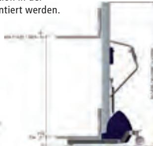
! Die Plattform kann um  $\pm 100$  mm von der Position in der Zeichnung entfernt montiert werden.
